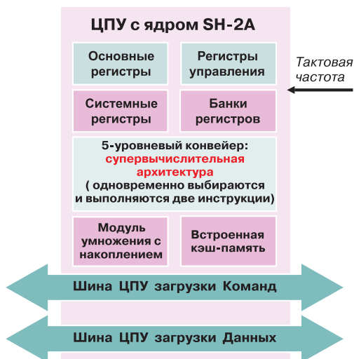
Рис. 7. Архитектура ядра SH-2A
