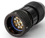
Kabelstecker, langer Adapter, 10-polig nach VG96934 Version J für Anschluss- und Verbindungskabel, verfügbar mit 5-Kodierlagen und Lötanschlüssen bis AWG20
