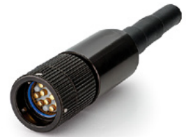
Kabelstecker mit Gummitülle, 10-polig nach VG96934 Version J für Anschluss- und Verbindungskabel, verfügbar mit 5-Kodierlagen und Lötanschlüssen bis AWG20
