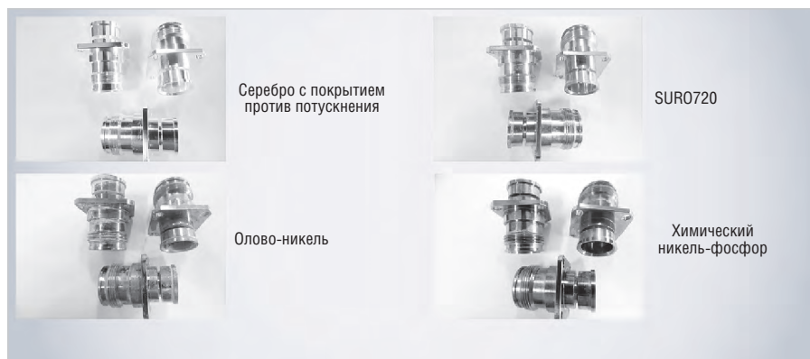
Рис. 6. Коррозия образцов после испытания в соляном тумане 720 ч
