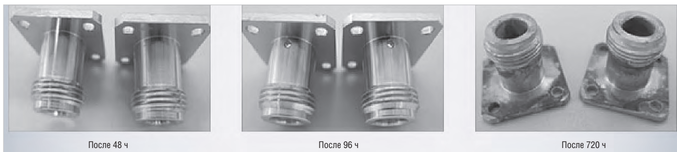
Рис. 5. Стандартная белая бронза (триметалл) после 48, 96 и 720 ч испытаний в соляном тумане
