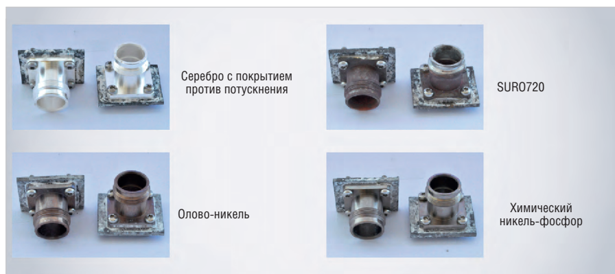
Рис. 7. Коррозия образцов после 720 ч испытания в соляном тумане на алюминии (без изоляции)
